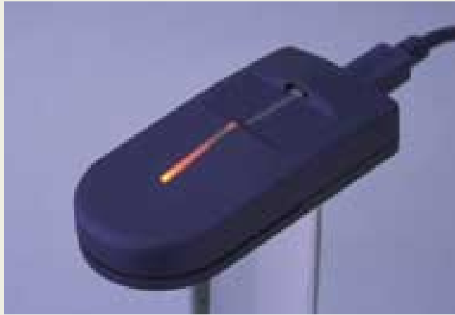
図4 ライン型指紋センサを採用したユニット
