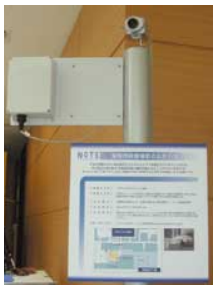
図1 NGNフィールドトライアル「ユビキタス見守り」 (チェックポイントのタグリーダとネットワークカメラ)
