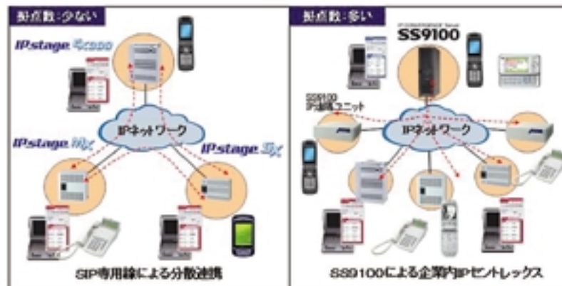
図2 システム間のSIP連携により高いスケーラビリティを実現
