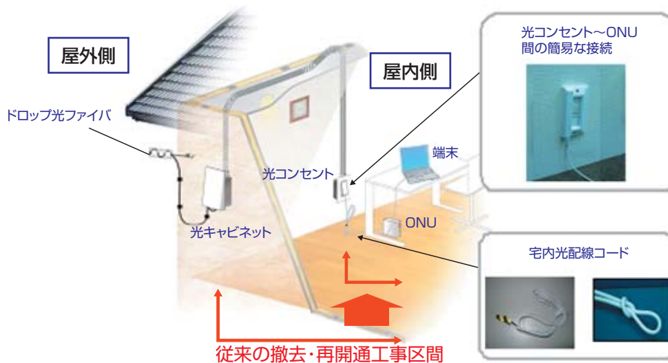
図4 光配線の撤去・再開通工事の簡素化
