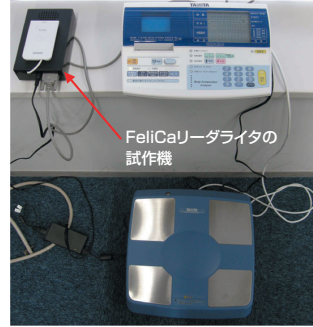
写真1 検証中のFeliCa対応体組成計(試作機)
