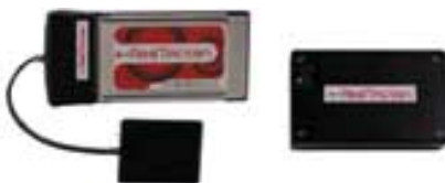
写真1 RedTactonトランシーバのプロトタイプ (左: PCカード型、右: ハブ型)
