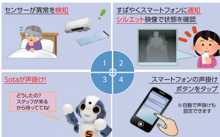
図1 介護事業所向け見守りロボットサービスの概要
