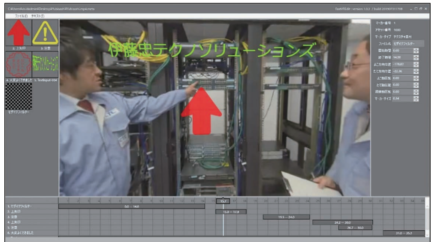
図2 VR動画に対し簡単にテキストやイメージを挿入できる編集画面
