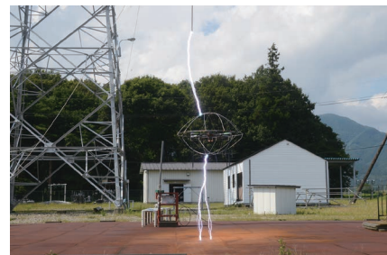
図2 耐雷ドローンへの人工雷印加試験の例
