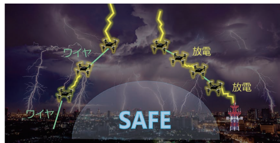
B.ドローン群で広いエリアを守る
