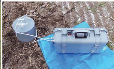
図3 大気中と地中のGHG放出量の測定
