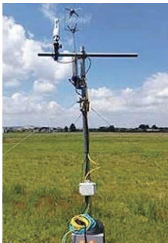
図3 大気中と地中のGHG放出量の測定
