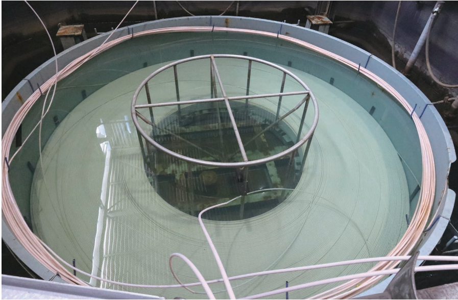
図2 実際の伝送実験で用いたマルチコア海底試作ケーブル（約15km長）
