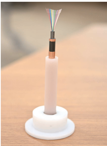
図1 マルチコア光ファイバのプロトタイプ 光ファイバ1本1本の中に、 4つのコアが通っている。
