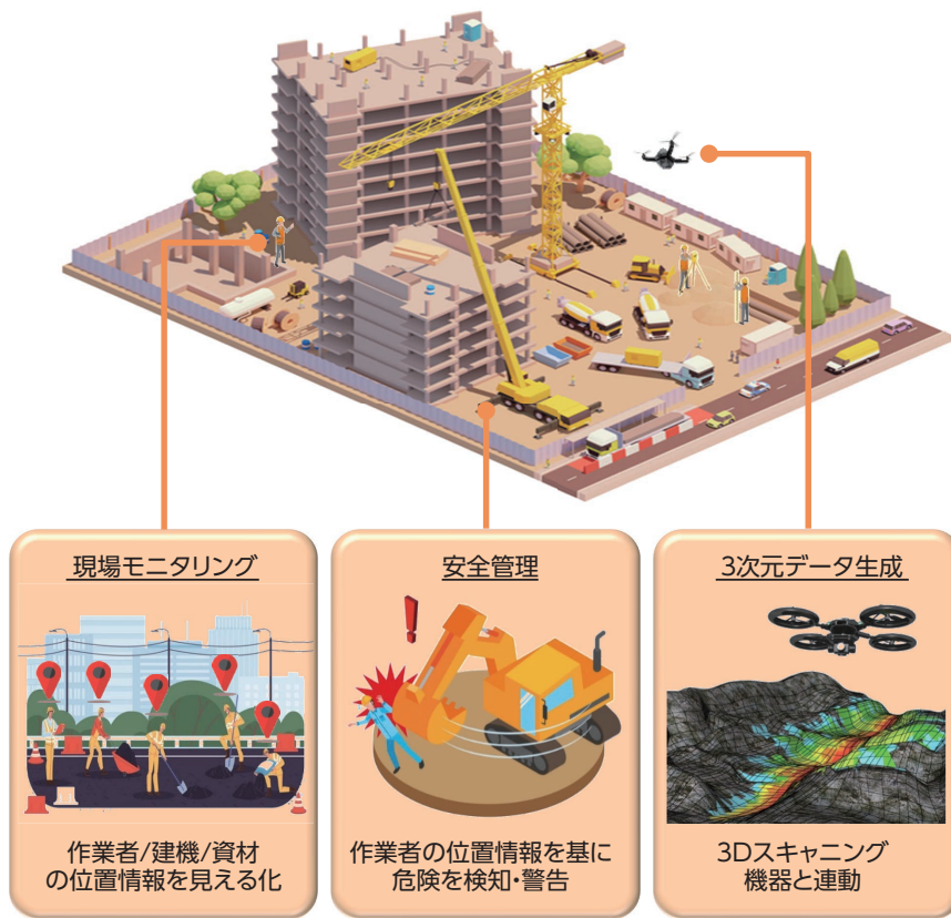
図 14 建設現場での活用イメージ
