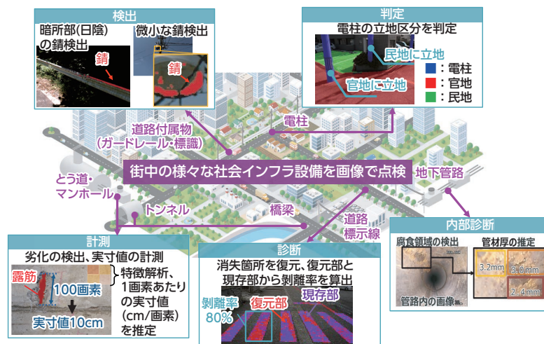
図3 画像認識を用いたインフラ設備の点検診断技術
